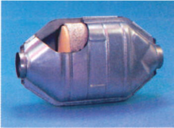
جوره بگورپکی هاندەر، که له ئۆتۆموبیلدا به کار دیت، پارچه یه کی لی بیدراوه تاکو ئه و ماده سیرامیکه کونیلهداره دهریکه ویت که وهک بنچینه یه کی بگورپکه کار دهکات.
