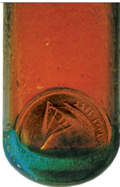
شېۋە 3-8 مس دەئۇكسىت و دوانۇكسىدى نىترۇجىن پەيدا دەبىت، كاتىك پارچە دراۋىك دەخرىتە گىراۋەيەكى خەستى ترشى نىترىكەۋە.
