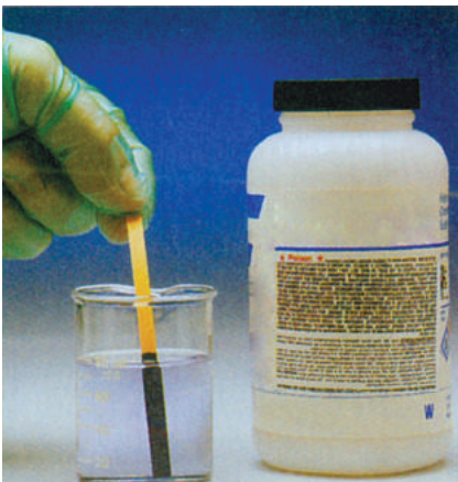
شېوھ 3-5 رېنگى كاغەزى pH شىن دەبېت ئەگەر له گىراوھى ھايدروكسىدى سۆدېوم ھەلگېشرا.
